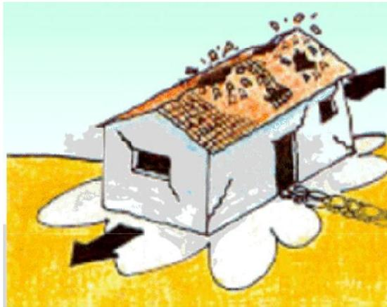
2. Los cimientos y la parte inferior de la estructura, por estar en contacto directo con el suelo, se mueven inmediatamente; sin embargo el techo permanece quieto por un instante.
