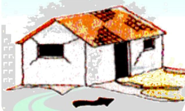
11. Si el terreno se mueve paralelo a aquellos muros que no son de carga, el daño será mayor y los muros longitudinales pueden caerse a lo largo de toda la casa y arrastrar con ellos a los muros transversales.
